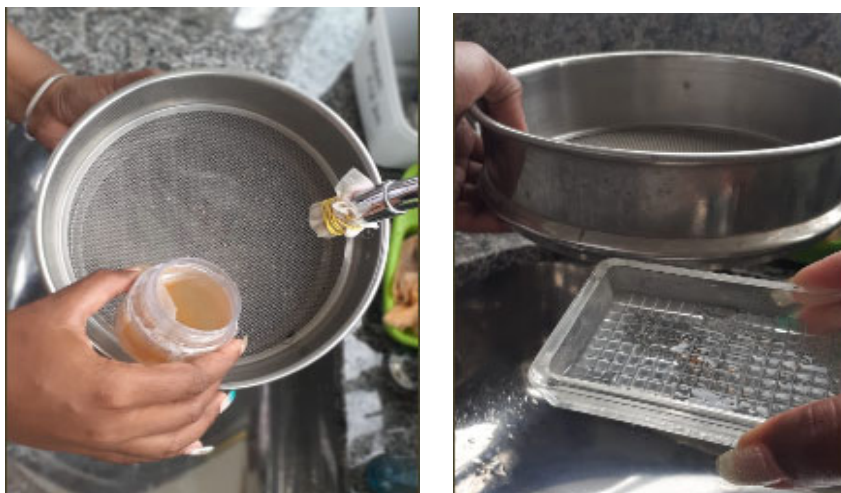
Figura 4: Processo de elutriação das amostras em laboratório
