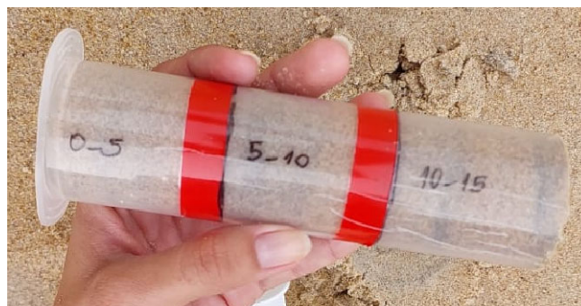
Figura 3: Coletor cilíndrico usado para coleta dos estratos
