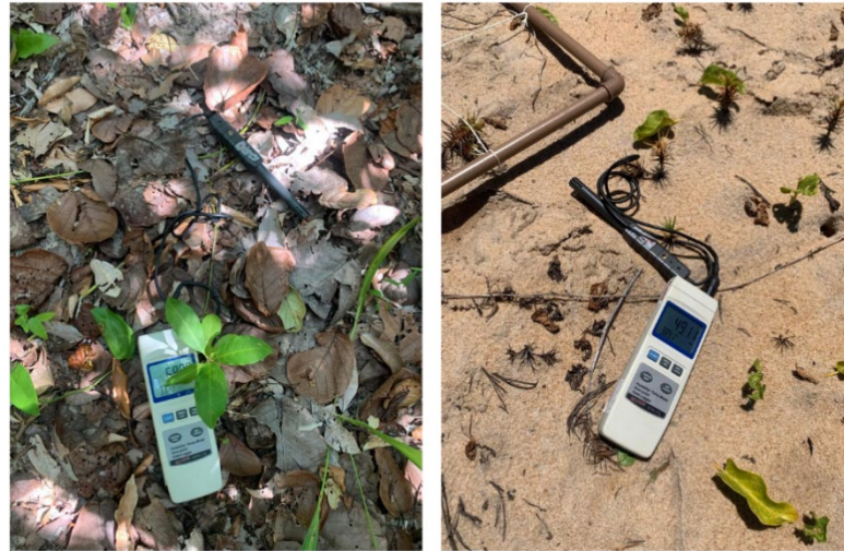
Figura 3 - Termo-higrômetro medindo temperatura e umidade no nível do solo, em diferentes pontos amostrais.
