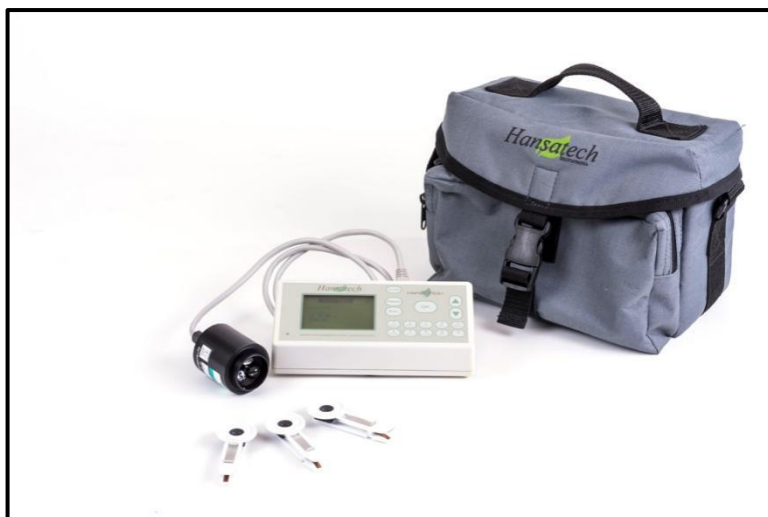
Figura 2- Fluorômetro portátil (Handy PEA, Hanstech, UK) e cliques foliares
