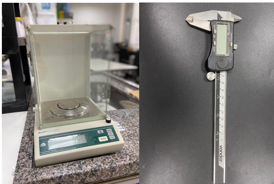
Figura 5: Balança analítica digital (à esquerda). Paquímetro digital (Vonder, com precisão de 0,01 mm) (à direita).
