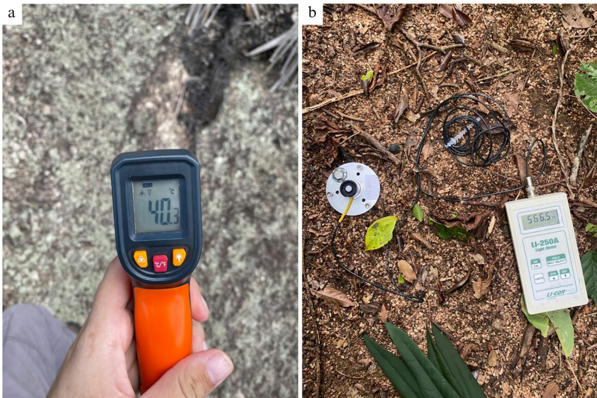
Figura 5: Equipamentos utilizados para medições de temperatura e luminosidade. a: Termômetro digital; b: Luxímetro.
