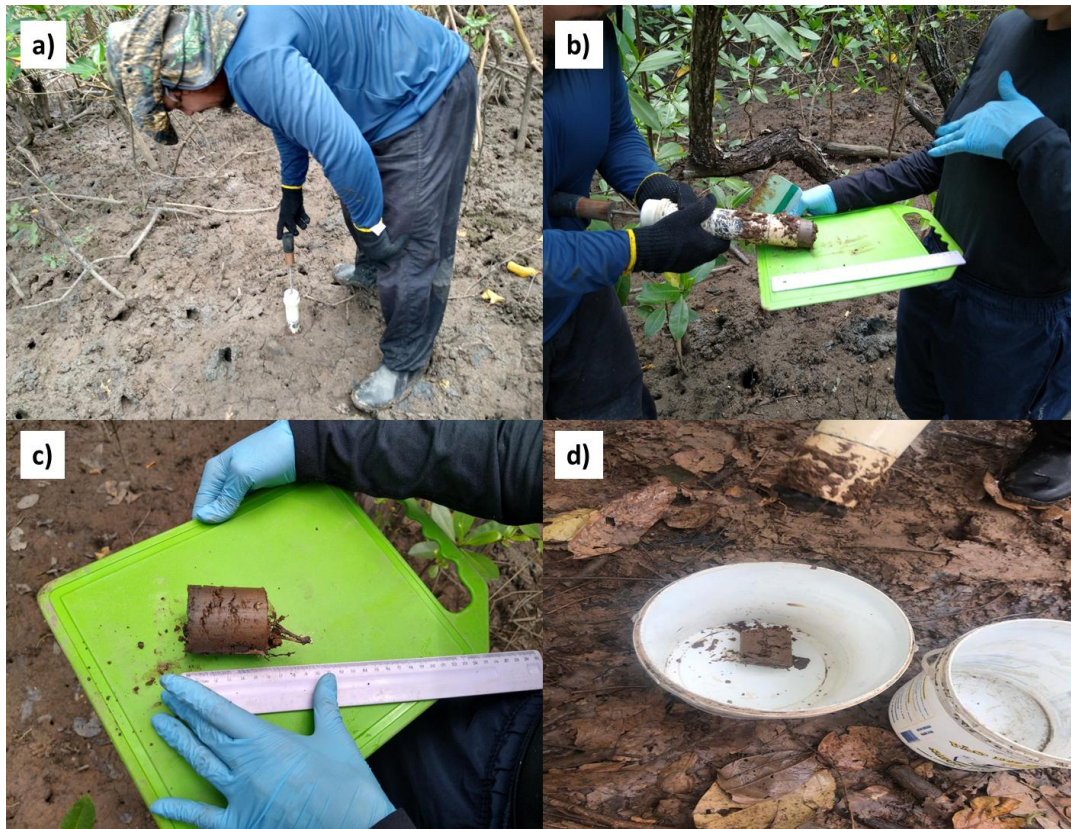
Figura 2: Processo de obtenção das amostras de sedimento: a) Coleta de sedimento in situ ; b) Extrusão do sedimento; c) Aferição da profundidade amostrada; d) Recipiente utilizado para homogeneização das amostras.
