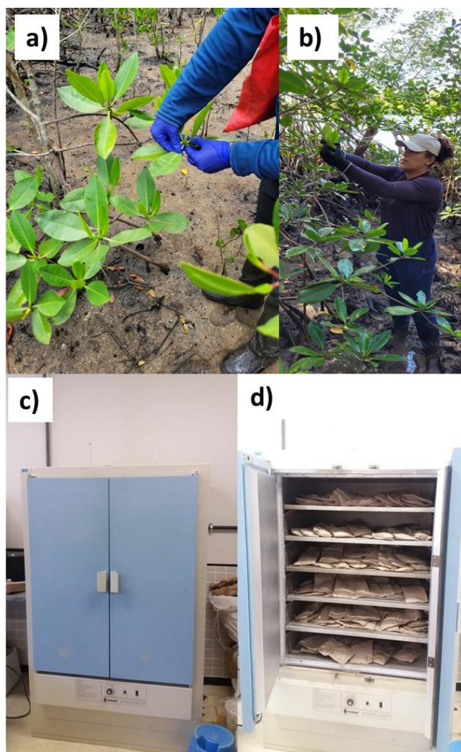
Figura 3: Processo de aquisição das folhas para análise de metais: Coleta de folhas em campo (a e b) e secagem das folhas na estufa em laboratório (c e d).
