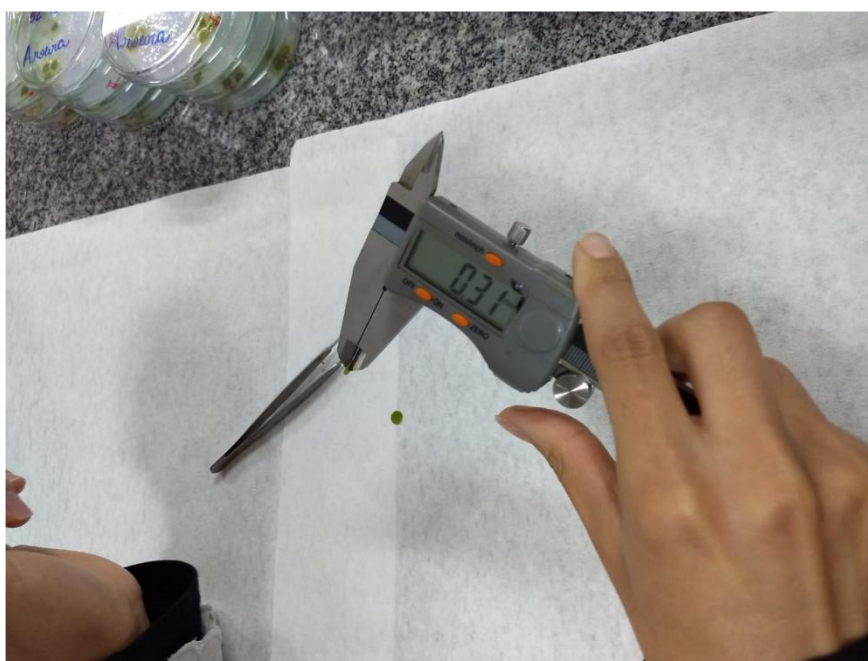
Figura 4. Medição da espessura (ESP) com paquímetro digital ( \pm 0,01 \text{ mm} ). Fonte: Própria.
