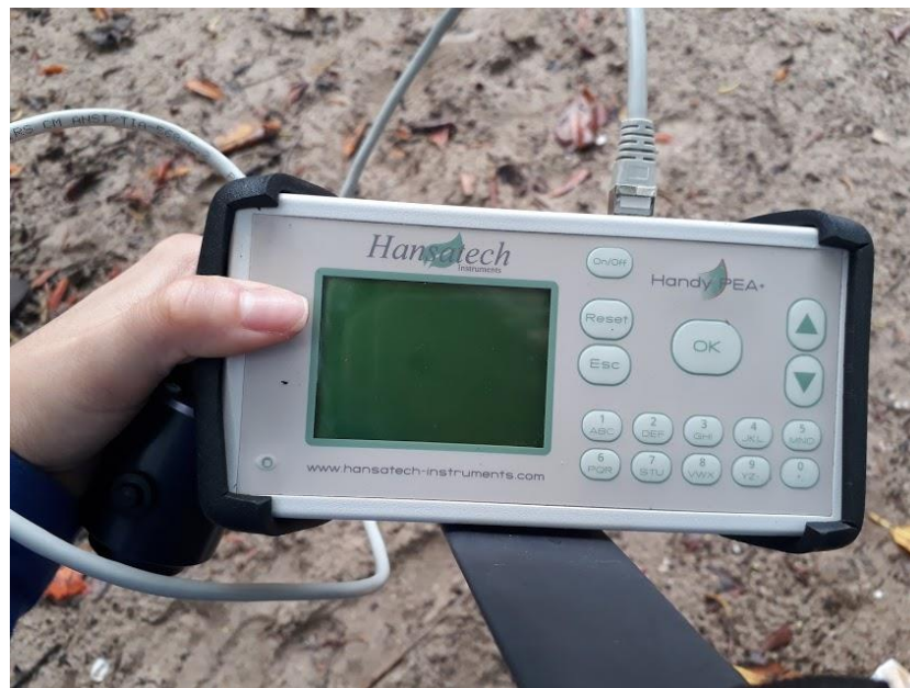
Figura 5. Fluorômetro não modulado Handy-PEA (Hansatech, UK) utilizado para medição da fluorescência transiente da clorofila a . Fonte: Própria.
