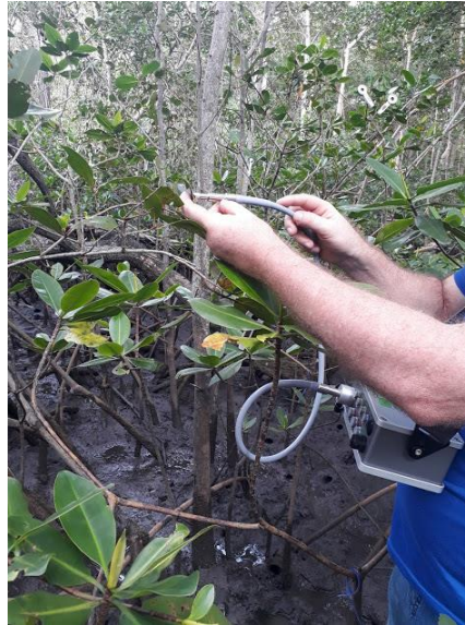
Figura 6. Medição da fluorescência modulada da clorofila a com fluorômetro modulado Mini-Pam, Heinz Walz, Effeltrich, Alemanha. Fonte: Própria.
